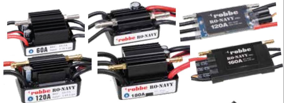
Fahrtregler mit vollwertiger Rückwärtsstufe für Elektro-Cars, Trucks und Schiffsmodelle.
